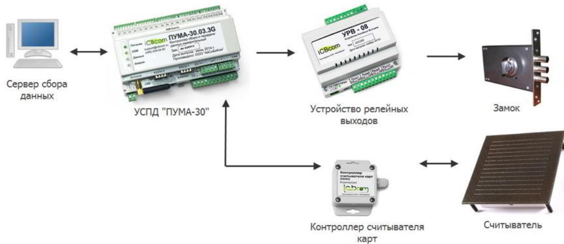
Рисунок 3 – Схема взаимодействия контроллера
